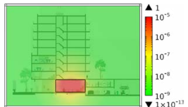
Traforuimte adequaat afgeschermd met MuFerro
