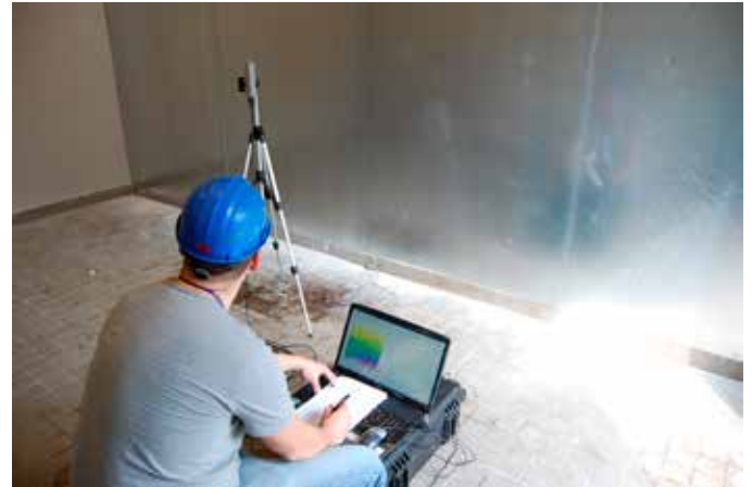
Magnetische veldsterkte meting na afscherming
