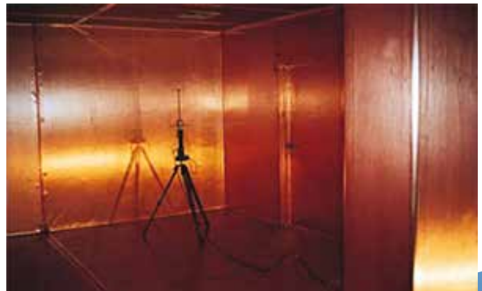
Opstelling test-antenne in mu-copper afgeschermd ruimte
