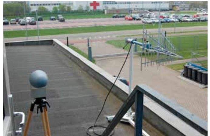
Elektrische veldsterkte meting op locatie
